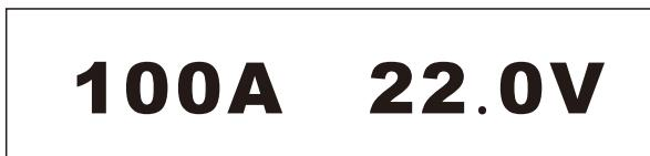
停止焊接后会显示焊接过程最后1秒的实际电流和实际电压。
