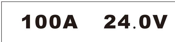
停止焊接后自动恢复显示焊接参数和实际电压。
