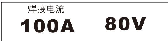
按下并松开左编码器可以依次选择“焊接电流”、“电弧推力”、“起弧电流”、“起弧时间”，可以循环选择；
