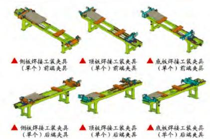
式，各个工件都有定位系统，使装卸工件方便、快捷。工装夹具还配有手动丝杠调整机构，有效调整行程为1.2米，以满足非标壳体的小批量焊接需要。
